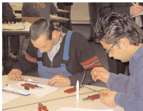
Zwei Jugendliche messen die Längen zum Biegepunkt aus und zeichnen diese Länge am Draht an
